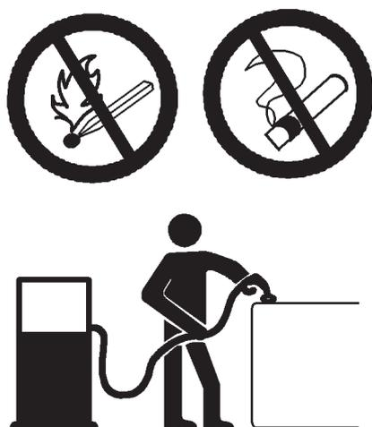
Schwefelgehalt (ULSD) birgt eine größere statische Zündgefahr als frühere Dieselmotorkraftstoffe mit höherem Schwefelgehalt. Tödliche Unfälle oder schwere Verletzungen durch Feuer oder Explosion müssen vermieden werden. Wenden Sie sich an Ihren Kraftstoff- oder Kraftstoffsystemlieferanten, um sicherzustellen, dass das Zufuhrsystem den Kraftstoffnormen für eine ordnungsgemäße Erdung und Masseverbindung entspricht.
